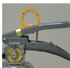
× レバー支えの脱落
