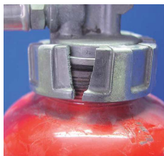
× キャップの破損
