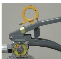
× 安全栓の抜けかけ
