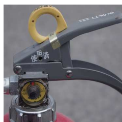
× 表示装置の脱落
