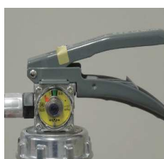
× 安全栓の脱落
